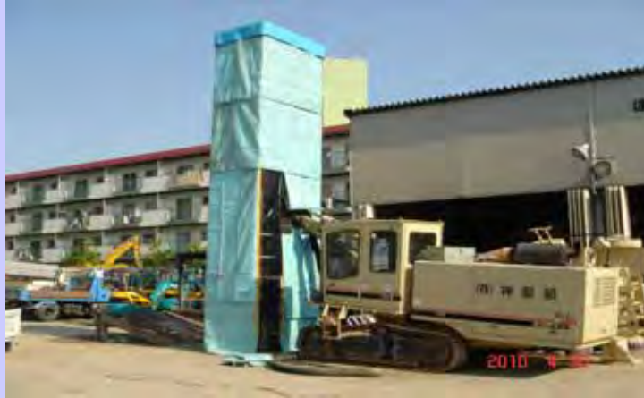
ダブル防音 “もっと静かに”「スーパー静マル君」BOXタイプ 特許工法
