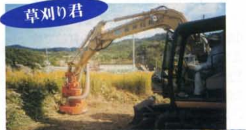
バックホーのバケット代わりに取り付ける「草刈り君」。アームを操作すれば、斜面でも楽に作業できる
