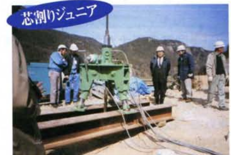
「芯割り君」を軽量・コンパクトにした弟分「芯割りジュニア」。機械先端部を差し込む穴は直径10cm、深さは掘削予定深度よりプラス30cmで済む
