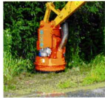
写真 - 15 刈取りと同時に粉碎・吸引
