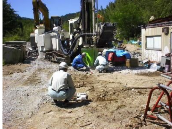
実験状況(騒音・振動測定)
